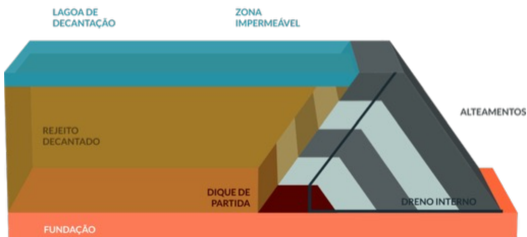
Figura 6.2 - Método construtivo de alteamento ‘a jusante’
