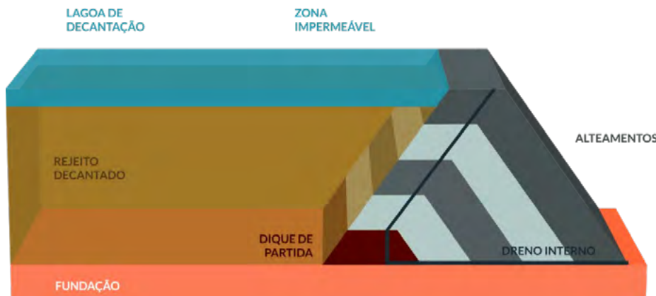
Figura 5.2 - Método construtivo de alteamento "a jusante"
